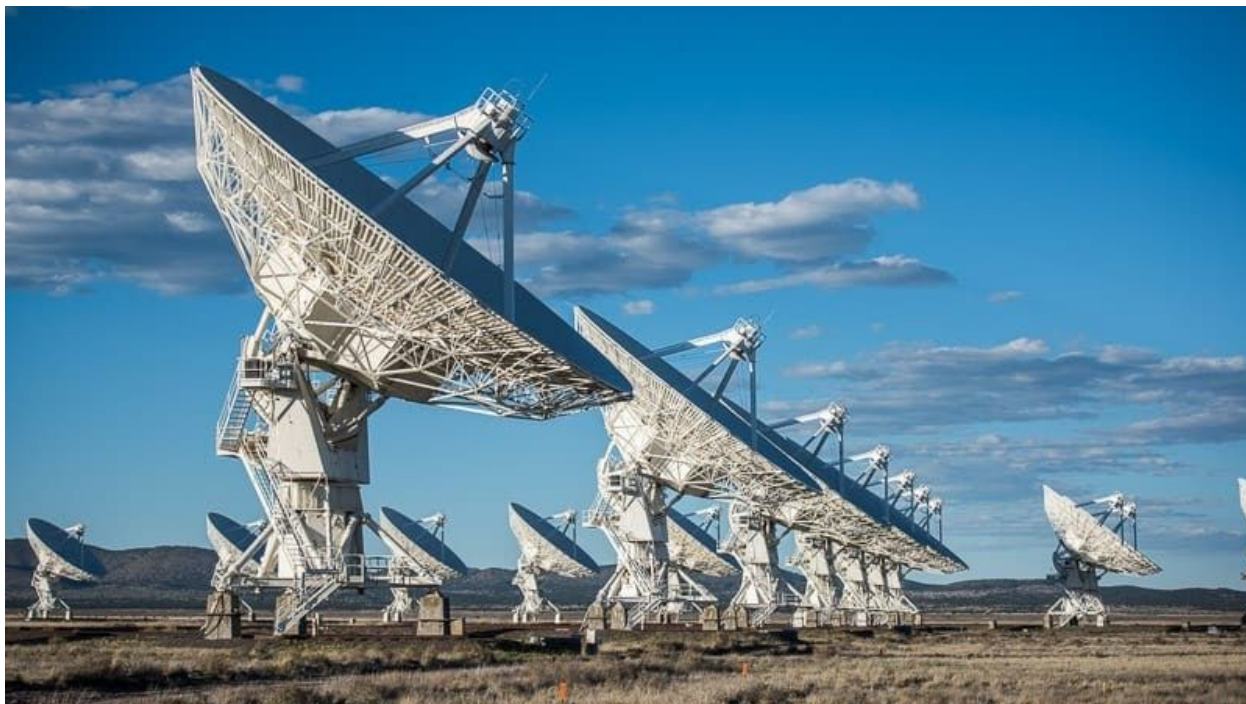
Εικόνα 3: Η πολύ μεγάλη διάταξη (VLA) είναι μία από τις πιο εξελιγμένες συστοιχίες ραδιοτηλεσκοπίων στον κόσμο, αποτελούμενη από είκοσι επτά ραδιοφωνικές κεραίες μήκους 25 μέτρων που μπορούν να λειτουργήσουν ως ραδιοσυχνόμετρο υψηλής ευκρίνειας.
